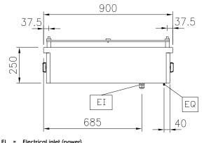
El = Electrical inlet (power) EQ = Equipotential screw
